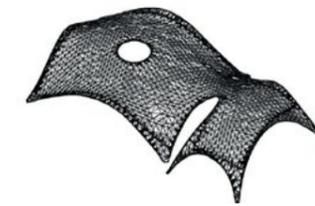
Réalisée sans murs porteurs, avec une portée de 36 mètres de long reposant sur 7 appuis, la membrane fine en béton est un défi structurel et architectural. Au niveau des appuis, l'épaisseur de la coque ne dépasse pas les 30 centimètres et atteint les 9 centimètres seulement au sommet de la voûte. Pour obtenir cette membrane réalisée en un seul tenant, il a fallu construire une immense résille en bois pour suppor-
